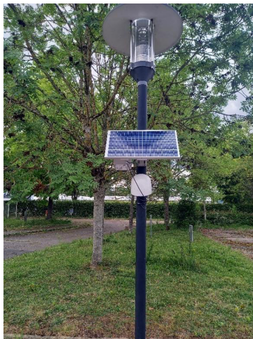
Illustration 7 : Micro-capteur Bettair et panneau photovoltaïque
