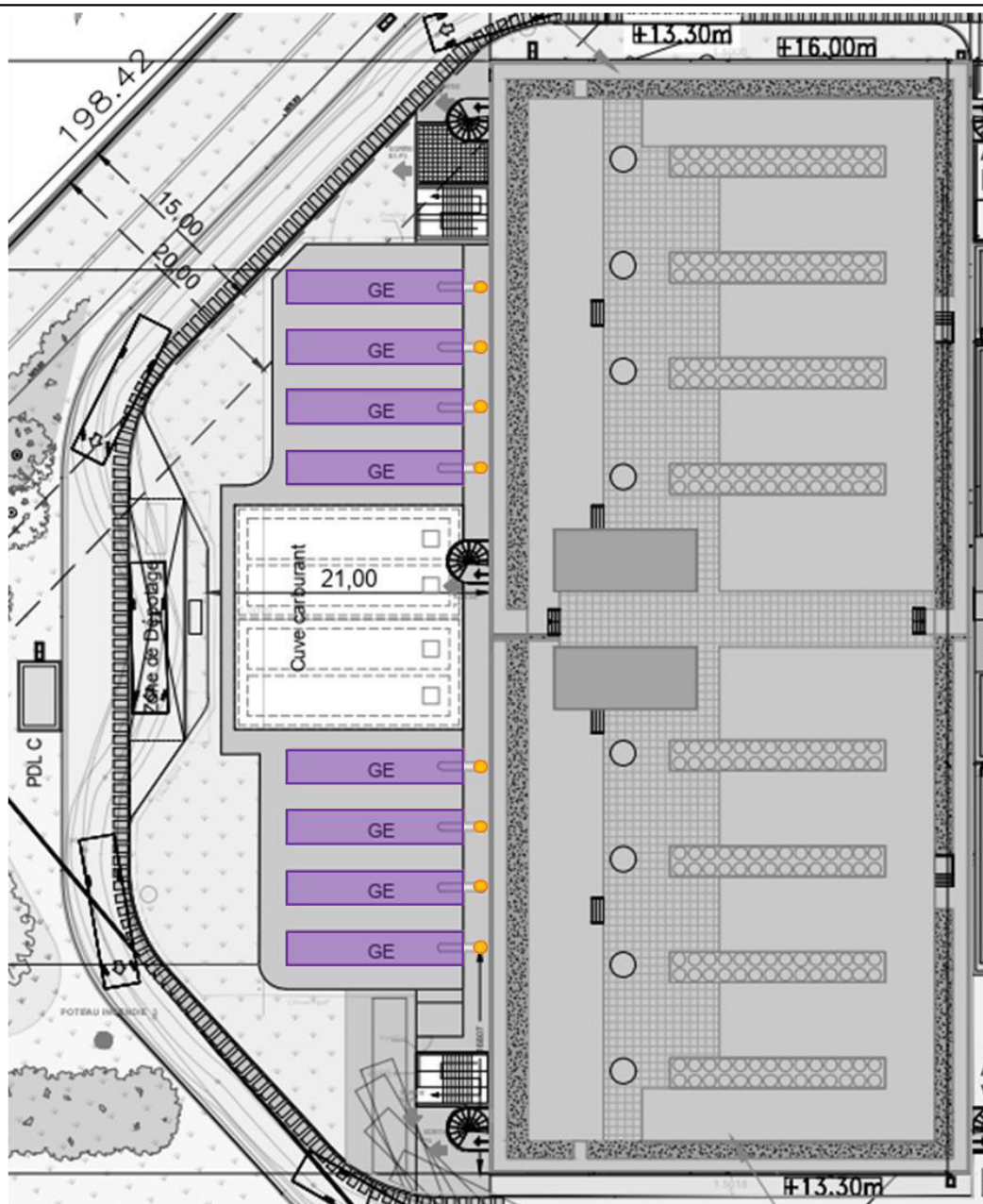
Illustration 50 : Localisation des containers groupe électrogène pour P34
