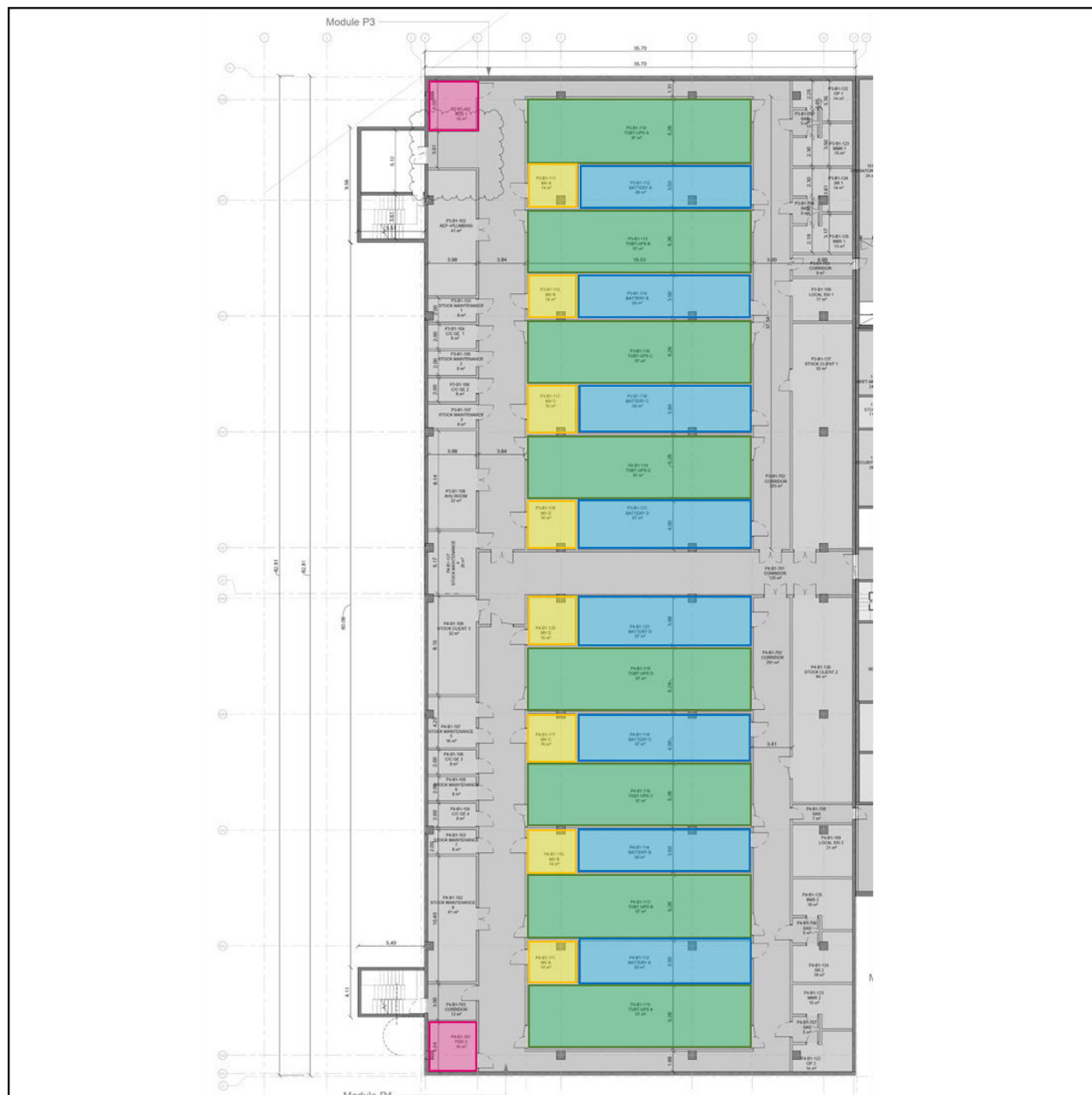
Illustration 49 : Localisation des différents locaux techniques électriques – Sous-sol
