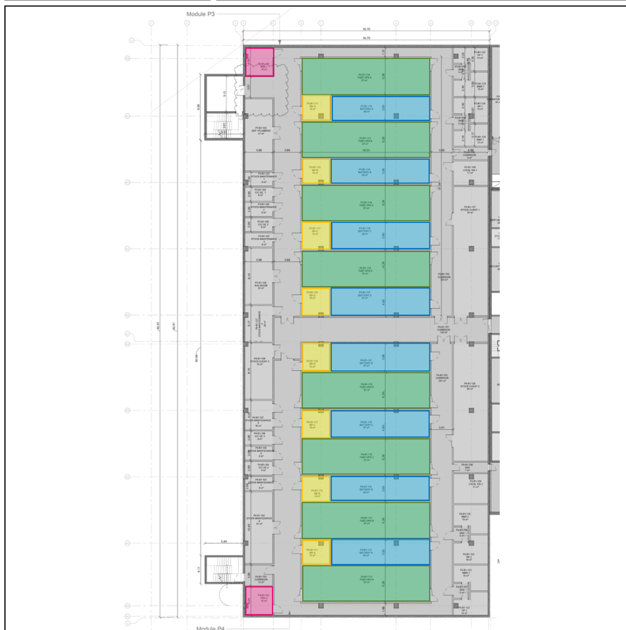
Illustration 12 : Localisation des différents locaux techniques électriques – Sous-sol
