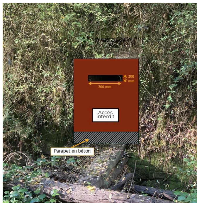
Figure 27 : Schéma de la porte de la chambre souterraine
