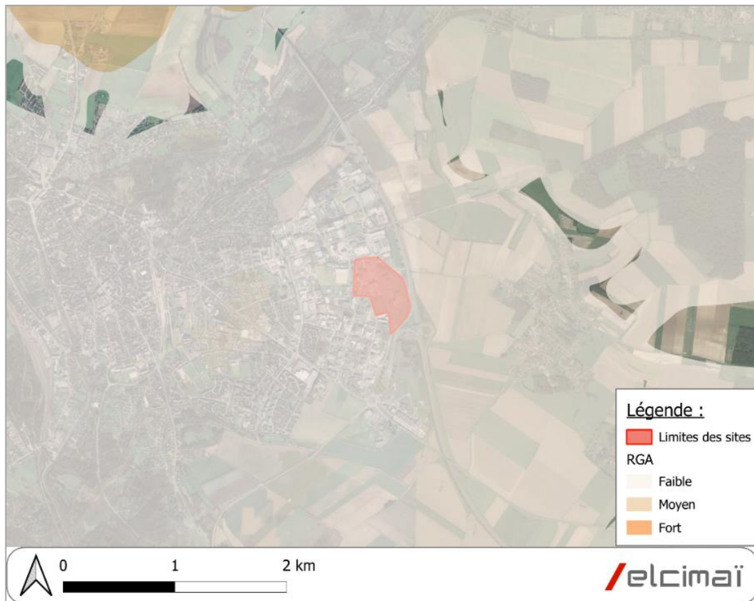
Figure 39 : Aléa retrait-gonflement des argiles dans le secteur d'étude (Source : Géorisques)
