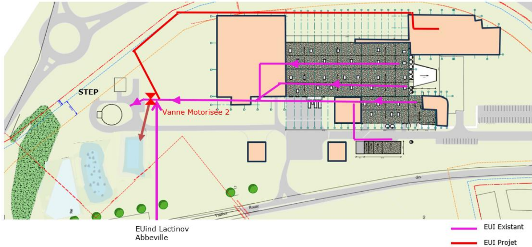
Figure 74 : Zonage d'assainissement EU Industrielles au niveau du site BABYDRINK projeté (Source : ELCIMAI Ingénierie)
