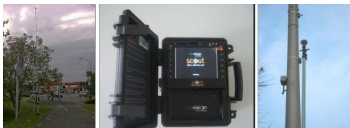
Figure 131 : Mât de comptage avec caméra et boîtier d'enregistrement
