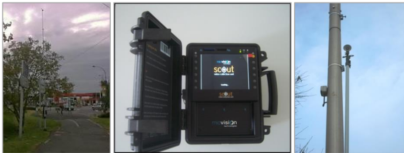
Mât de comptage avec caméra et boîtier d'enregistrement
