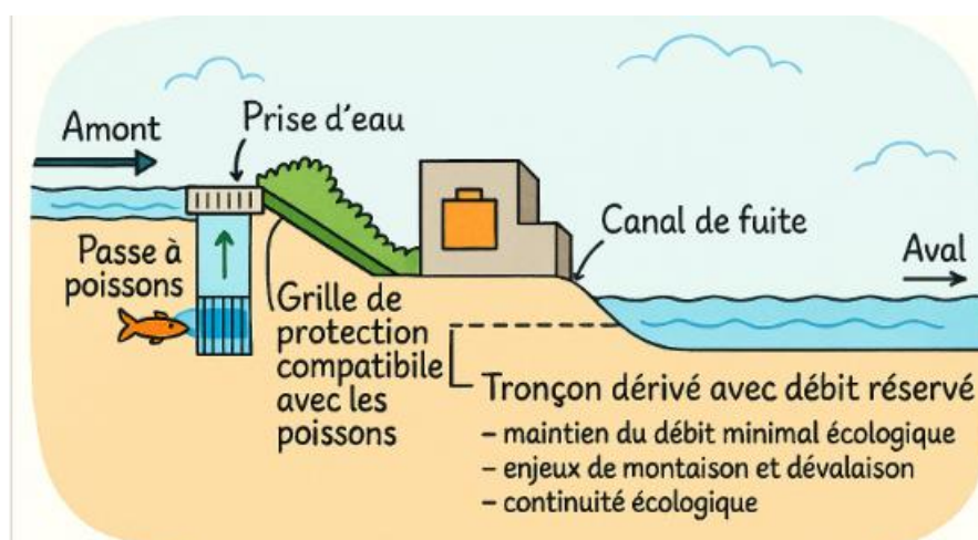
Schéma simplifié du fonctionnement d'une microcentrale
