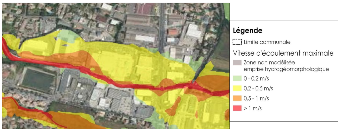
Figure 17 : Cartographie des vitesses d'écoulement au droit du Centre Commercial « La Rocade »
