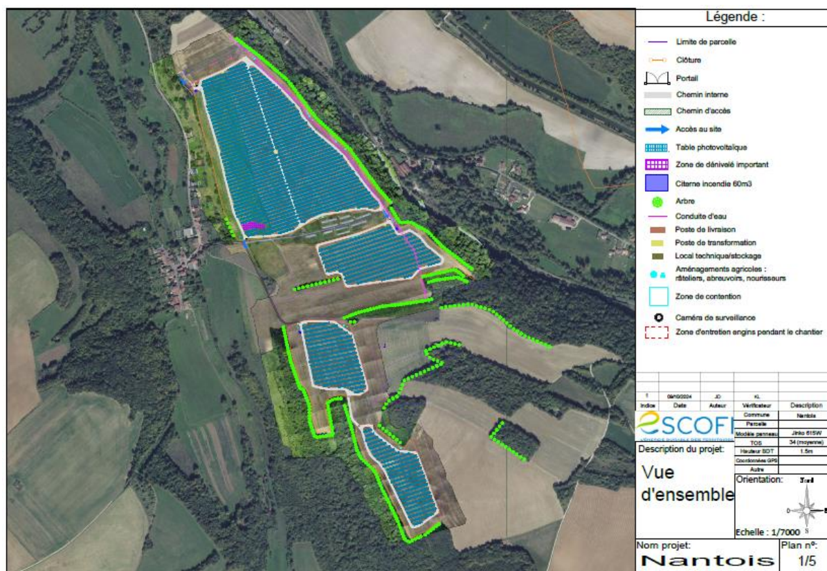
Figure 24 : Plan de masse du projet agrivoltaïque (Source : ESCOFI)
