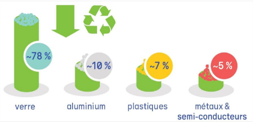
Figure 51 : Le traitement des panneaux photovoltaïques (Source : Soren)
