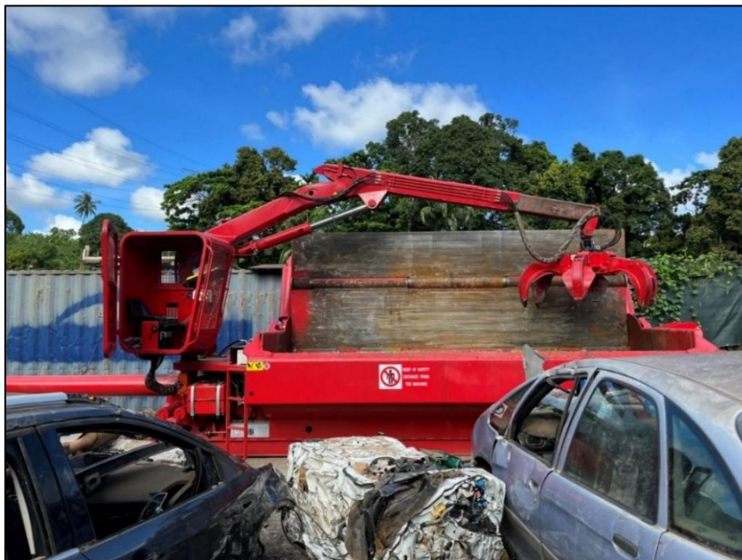
Figure 1 : Compacteur Colmar employée sur le site de Longoni avec résultat de compactage
