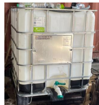
Figure 5 : Réservoir étanche de 1000 litres
