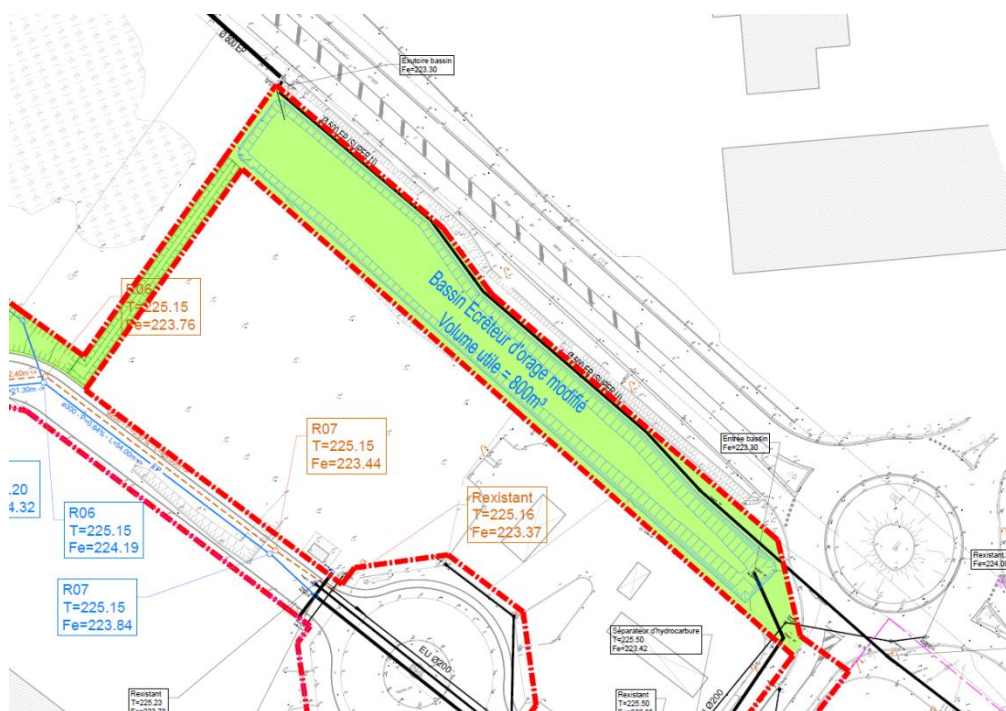
Figure 13 : Bassin de rétention
