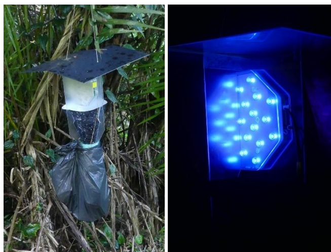
Figure 6 – Piège lumineux automatique sur site éteint (à gauche) et en fonctionnement (à droite) ; les insectes attirés percutent les écrans verticaux et tombent dans un collecteur situé à l'intérieur du sac noir. Photos Vincent LEGROS.
