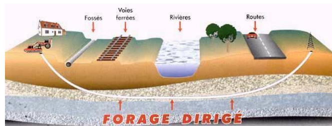
FIGURE 4 : EXEMPLE DE FORAGE DIRIGÉ (SOURCE : CONTANT.FR)
