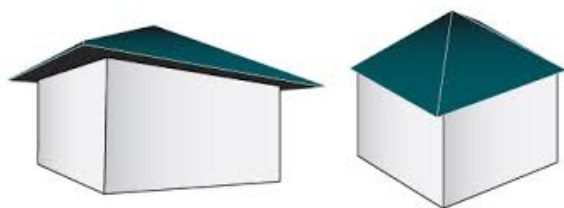
Figure 14 - Schéma illustratif (à titre indicatif) de la toiture en pointe de diamant
