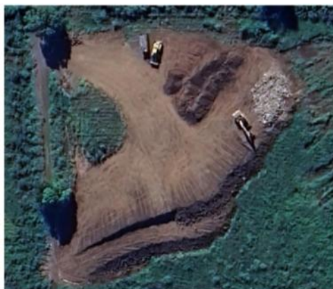
Figure 34: Remblaiement d’une parcelle agricole à 500 m en amont du forage avec des déchets inertes (Mascareignes Géologie, 2024 , source Google Earth mai 2023)
