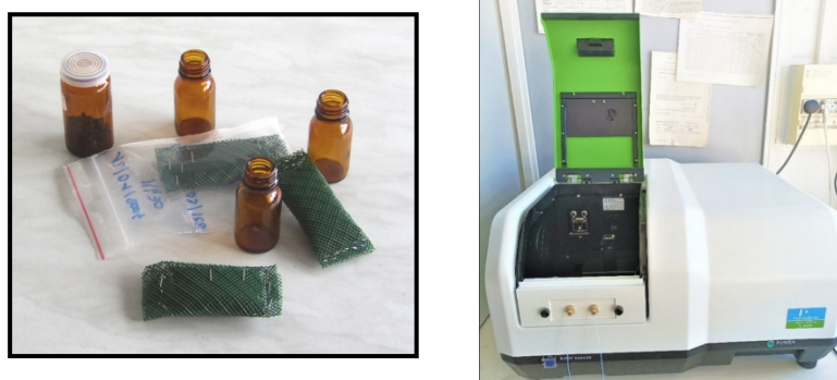
Figure 2 : Fluocapteurs ; Spectrofluorimètre LS-6500 de Sciences Environnement
