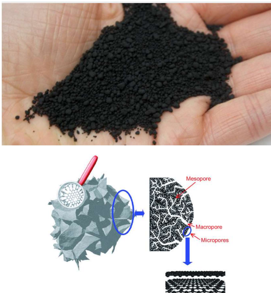
FIGURE 10 : EXEMPLE DE CHARBON ACTIF ET DE LA STRUCTURE INTERNE
