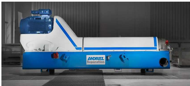
FIGURE 21 : EXEMPLE DE CENTRIFUGEUSE POUR LE TRAITEMENT DES BOUES- SOURCE ANDRITZ
