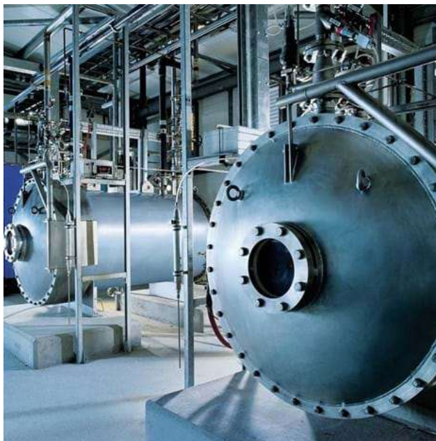
FIGURE 9 : EXEMPLE D'OZONATEUR – SOURCE XYLEM / WEDECO
