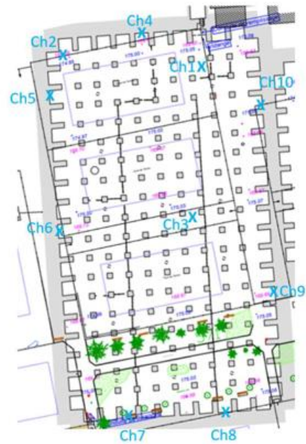
Figure 34 : Localisation des essais d'arrachement sur chevilles – grand réservoir
