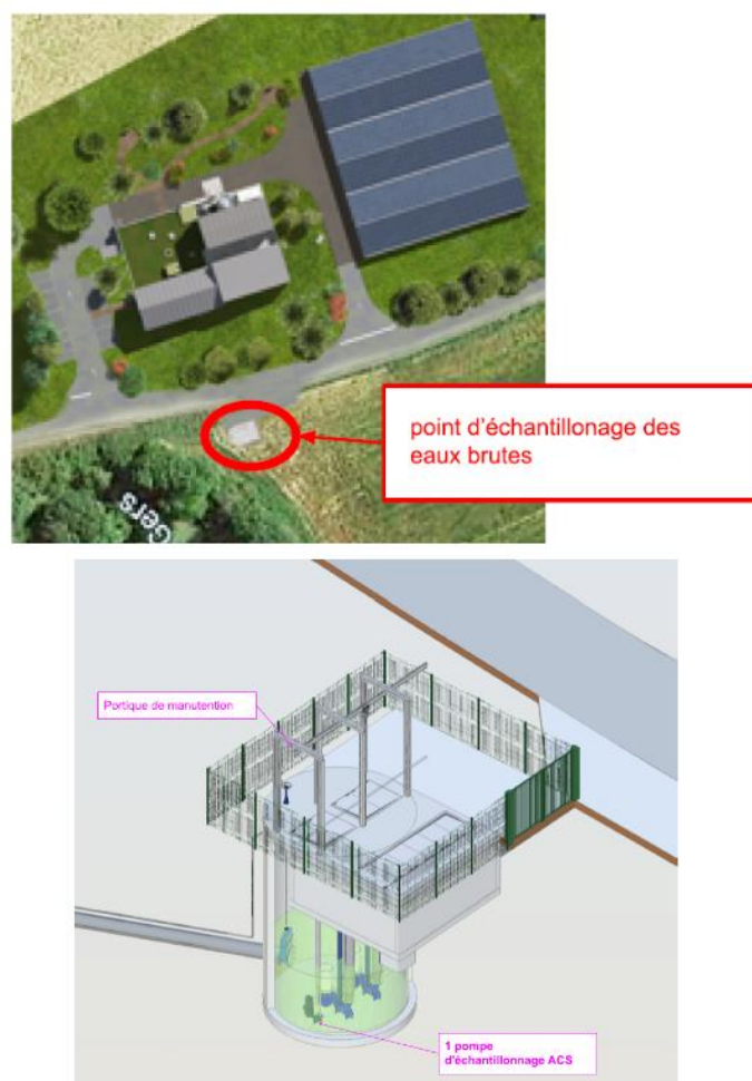
Figure 28 : Position du point d'échantillonnage et de la pompe ACS (Source : Mémoire process OTV)
