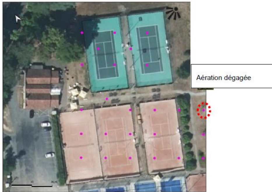
Figure 18 : Localisation des aérations
