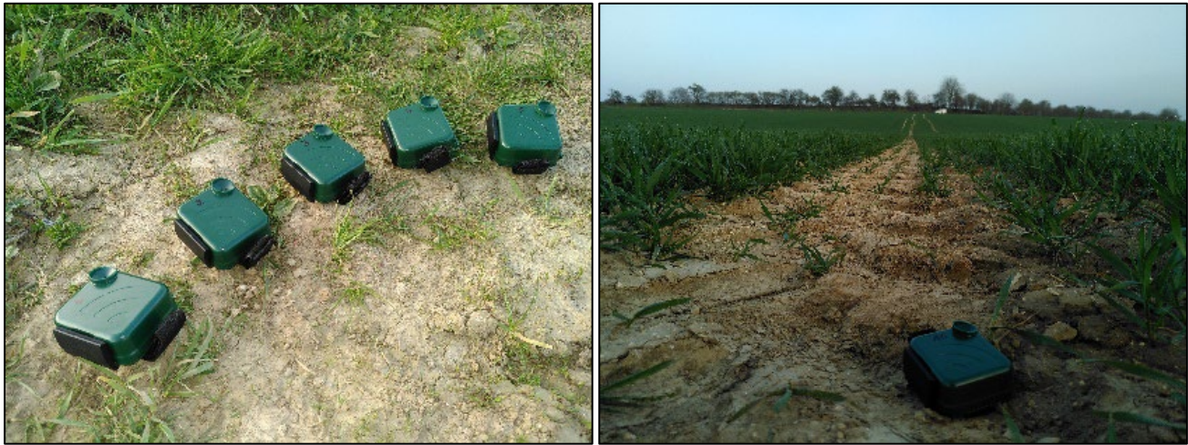
Photographie 1 : Appareils de type Audiomoths (TAUW France)
