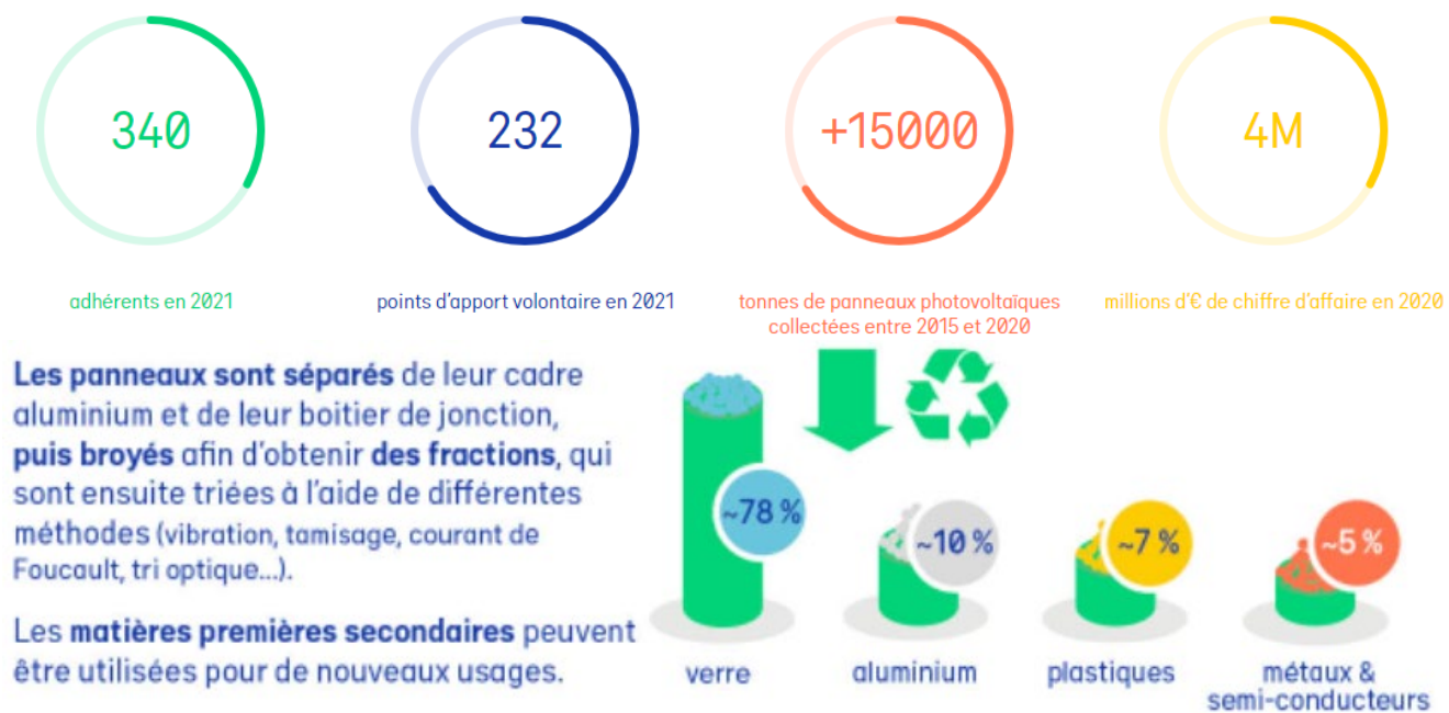
Figure 101 : Le traitement des panneaux photovoltaïques (source : Soren, 2022)
