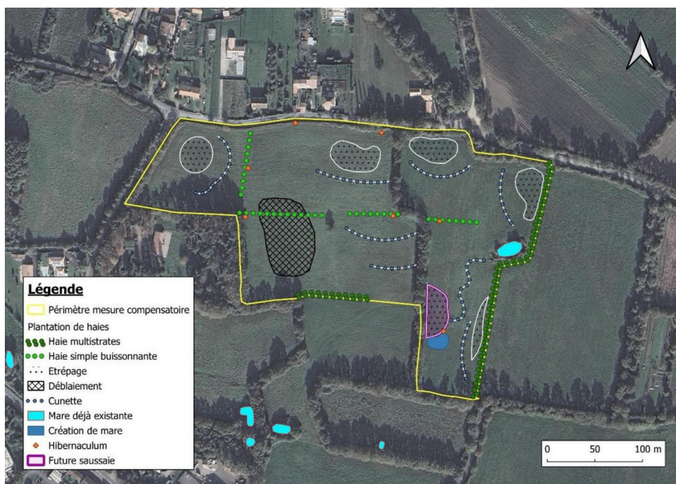
Plan de principe des mesures compensatoires – source dossier Loi sur l'eau
