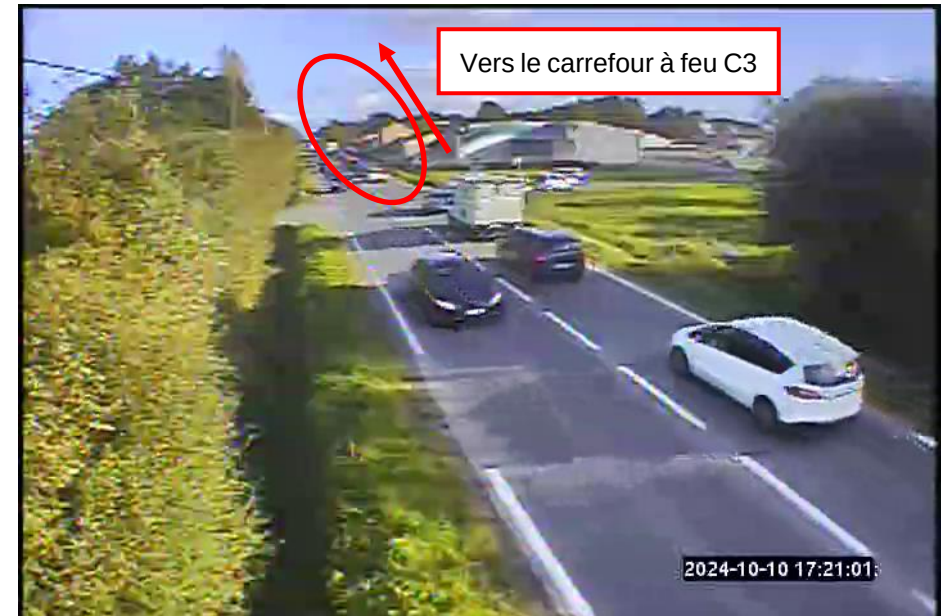
Files d'attente depuis le carrefour à feux C3 atteignant le carrefour C4 à 17h20
