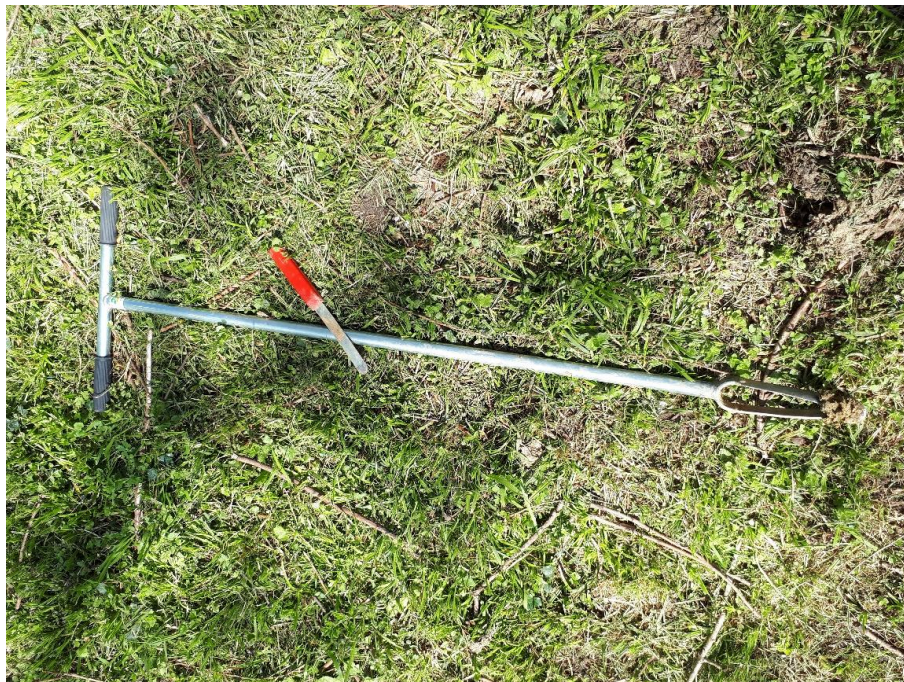
Figure 3 : Tarière utilisée pour les relevés pédologiques (Photo : Ecosphère)
