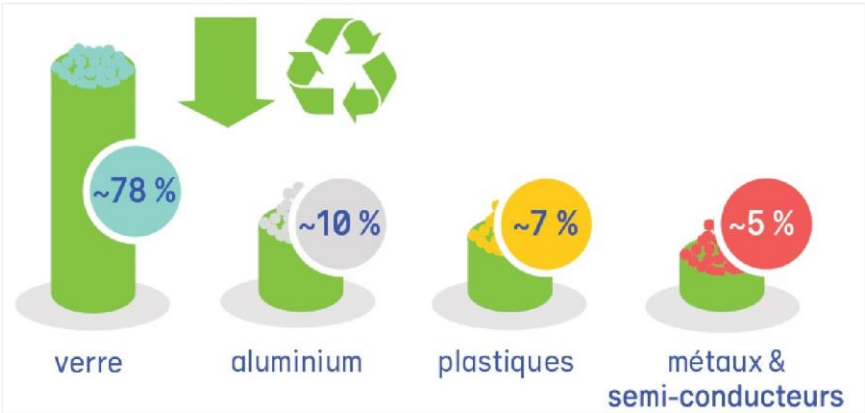
Figure 46 : Le traitement des panneaux photovoltaïques (Source : Soren)
