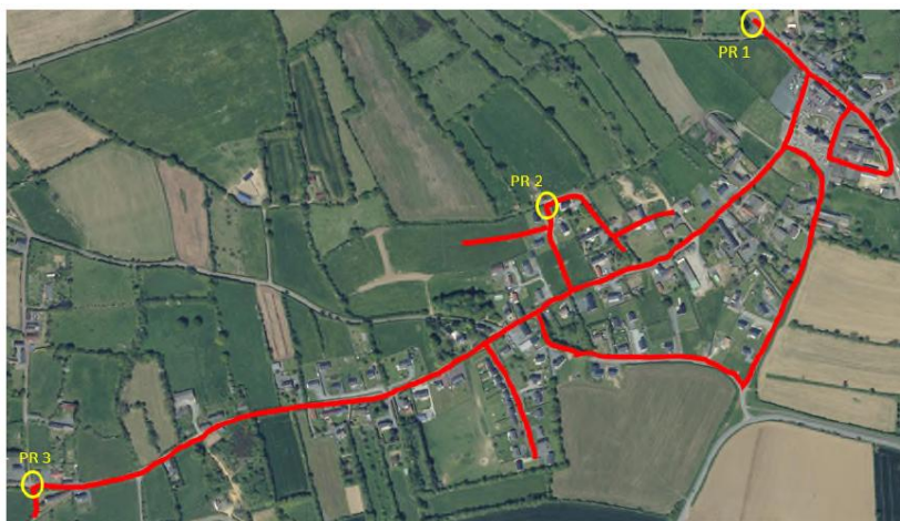
Figure 38. Projet 2.1 - Tracé de la canalisation (source SCE)
