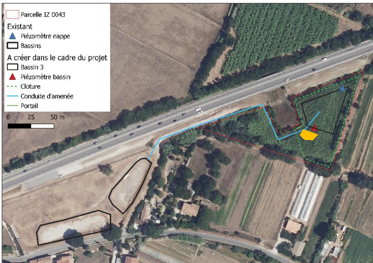
Figure 63 : Emprise des travaux pour la mise en place du second bassin Aquarenova
