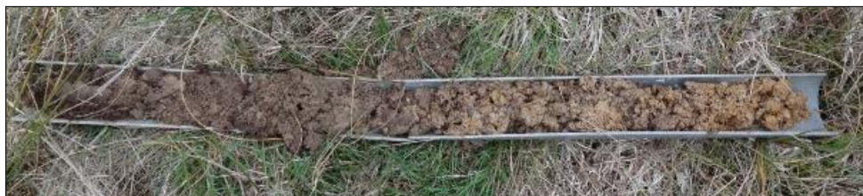
Figure 22 : Exemple d'une carotte de terre réalisée suite à un sondage.
