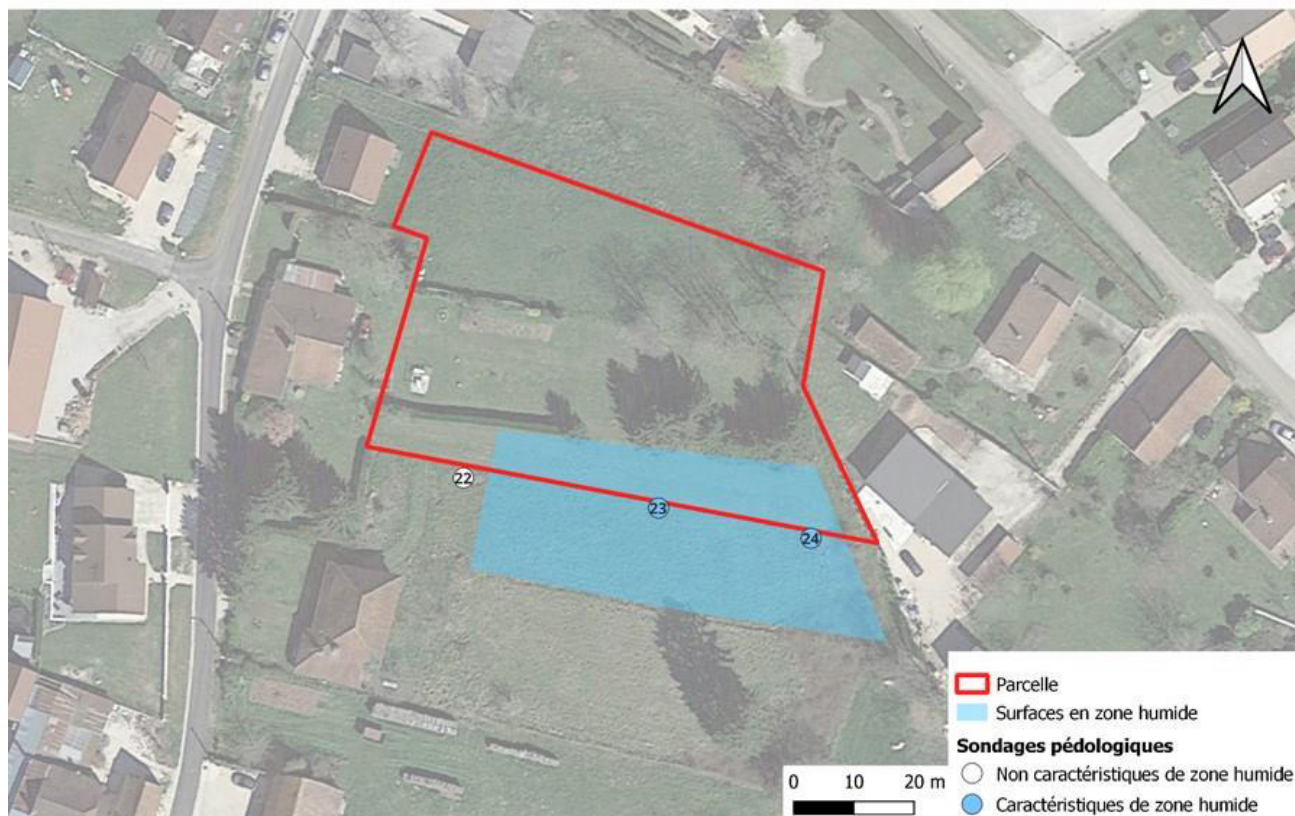
Illustration 5 : Résultats des sondages de sols dans le secteur 2
