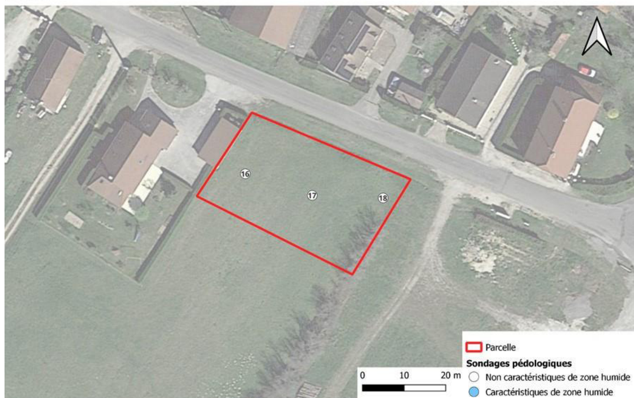
Illustration 8 : Résultats des sondages de sols dans le secteur 5
