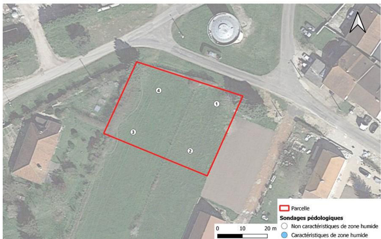
Illustration 7 : Résultats des sondages de sols dans le secteur 4
