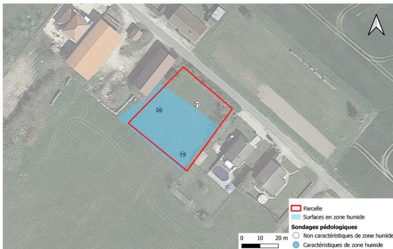
Illustration 9 : Résultats des sondages de sols dans le secteur 6
