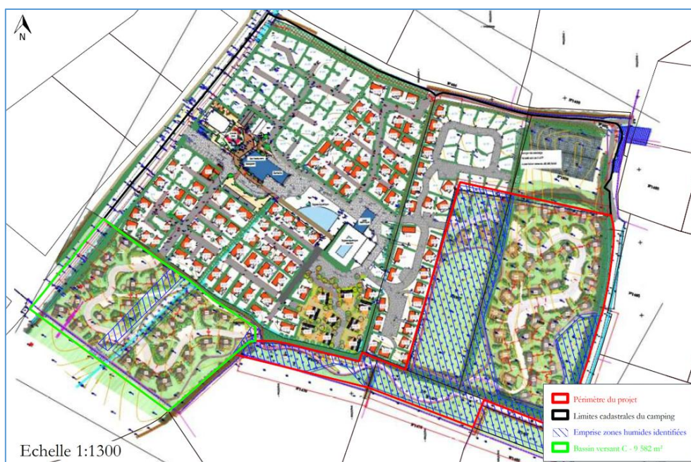
Figure 12 : Détails du périmètre du bassin versant C [JDAH, AGGRA Concept]
