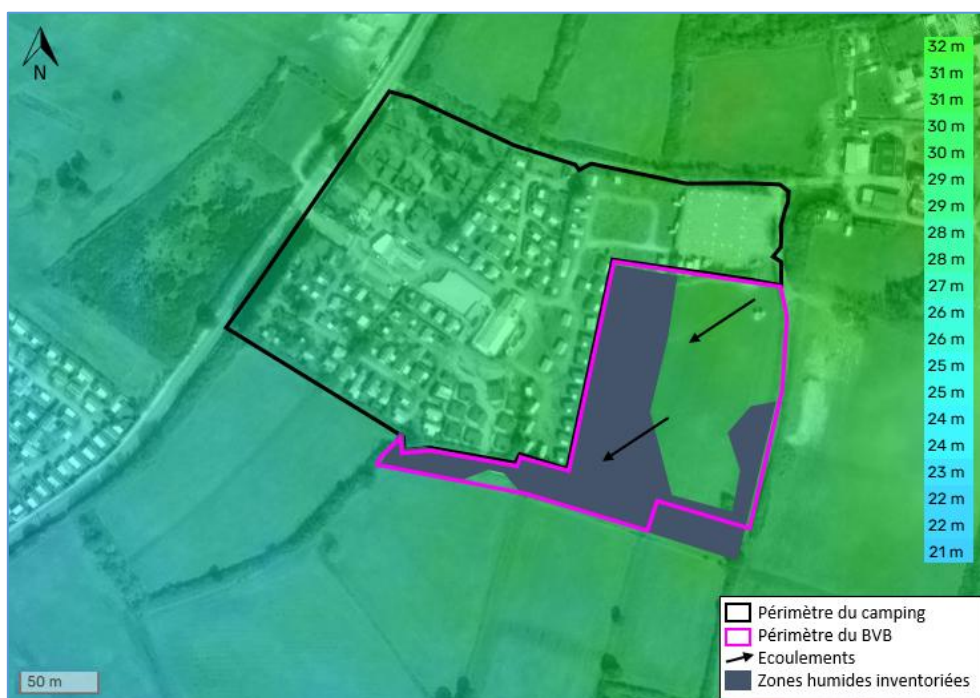
Figure 11 : Cartographie des écoulements à l'échelle du bassin versant B [AGGRA Concept, Topographic Map]
