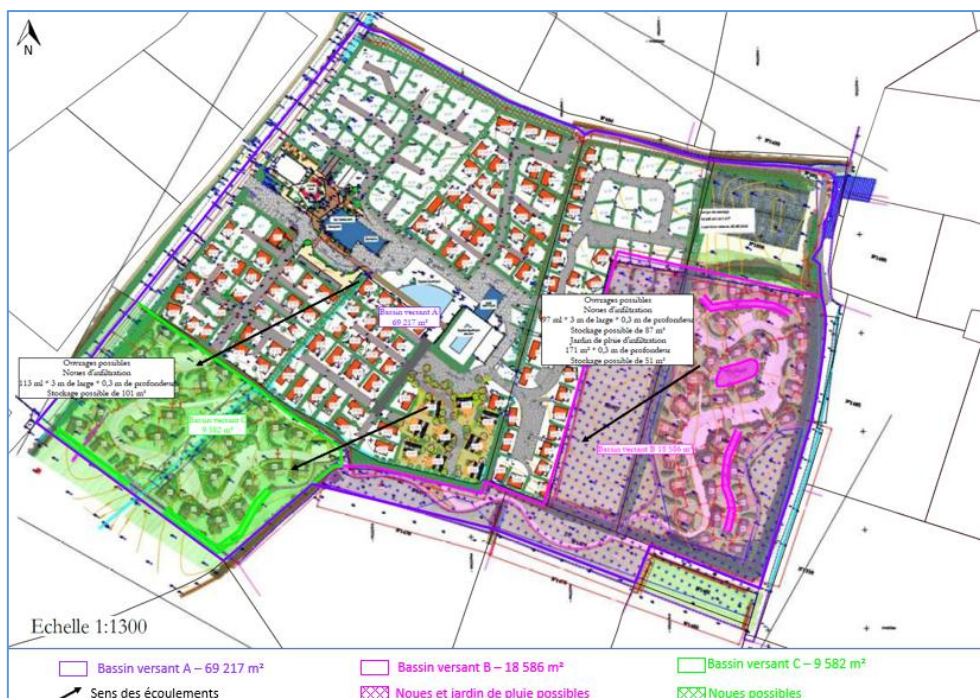
Figure 62 : Plan de la gestion possible des eaux pluviales futures sur le site (localisation des ouvrages et cheminement des écoulements) [AGGRA Concept, Avril 2026]
