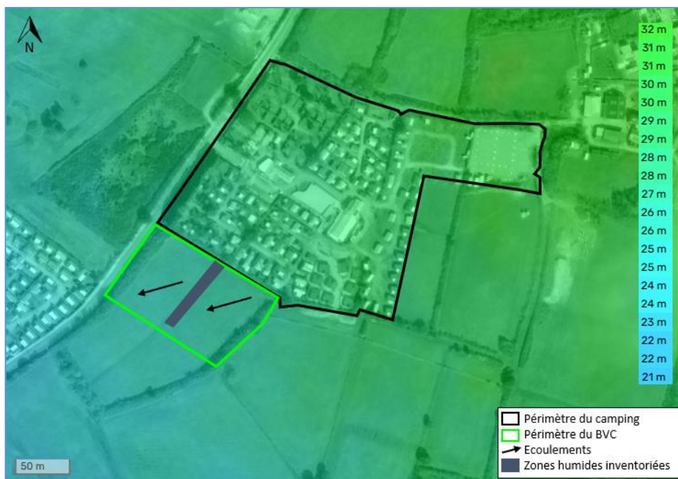
Figure 13 : Cartographie des écoulements à l'échelle du bassin versant C [AGGRA Concept, Topographic Map]
