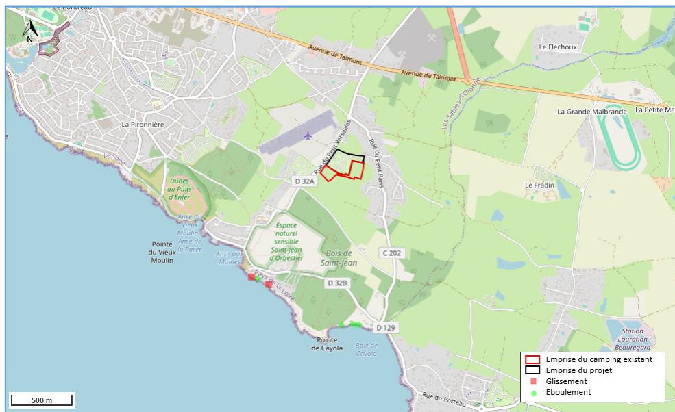
Figure 40 : Aléa mouvement de terrain au niveau du projet [Géorisques]
