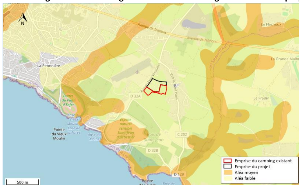
Figure 37 : Cartographie du site et du risque de retrait/gonflement des argiles [Géorisques, AGGRA Concept]
