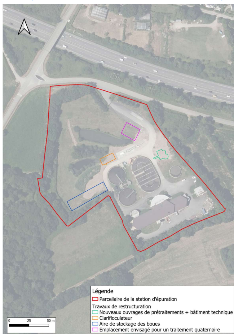
Figure 91 : Principe d'implantation des nouveaux ouvrages
