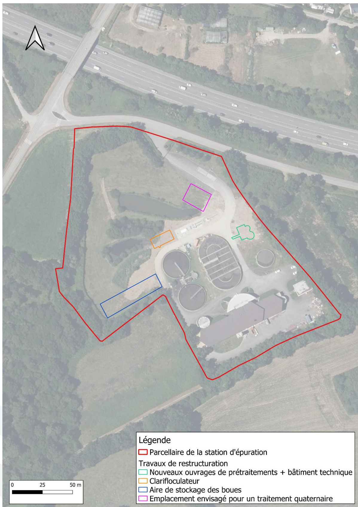
Figure 50 : Principe d'implantation des nouveaux ouvrages
