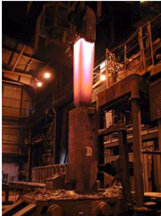
Photo 3 : Démoulage d'un lingot
