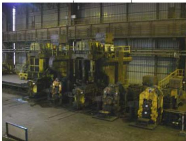
Photo 7 : Cages de laminages des billettes
