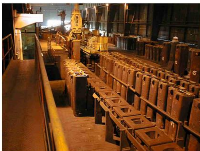
Photo 2 : Zone de stockage des lingots avant démoulage
