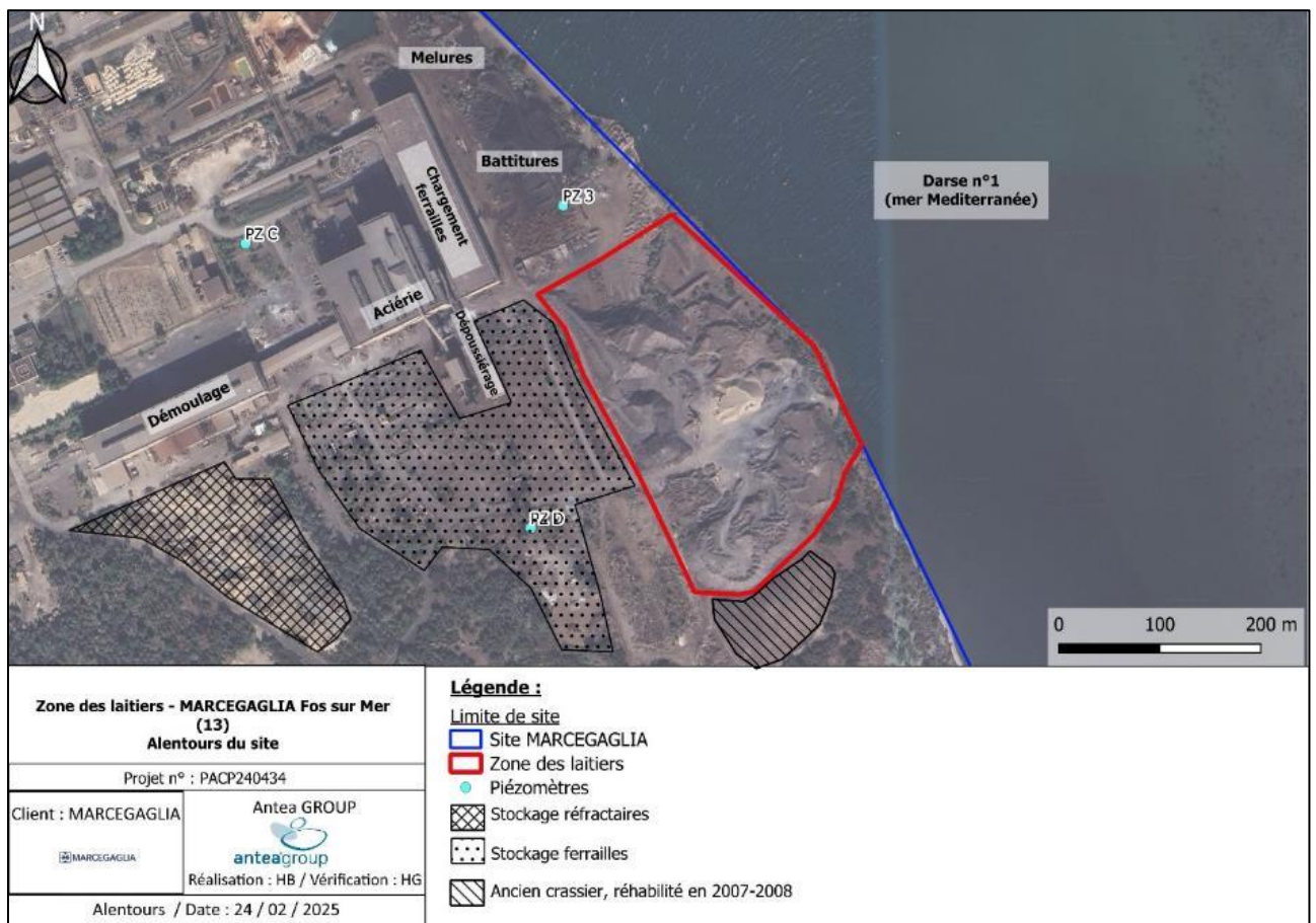
Figure 34: Abords immédiats d'entreposage des laitiers
