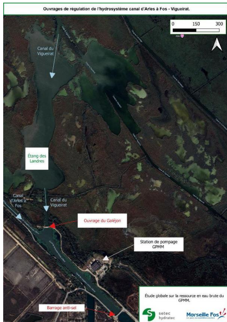
Figure II-2 : Ouvrages de régulations fonctionnels sur le canal d'Arles à Fos
