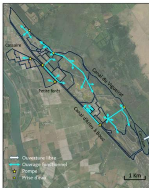
Figure III-13 : Ouvrages, pompes et prises d'eau du marais du Vigueirat (source : Tour du Valat, 2021).
