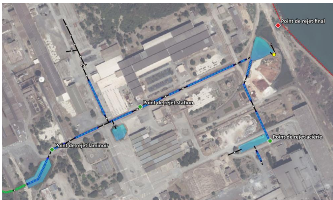
Figure 295: Points de rejets d'eaux industrielles existants dans le réseau de roubines
