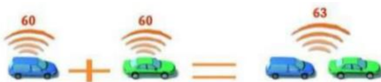
Figure 237 : Addition logarithmique des décibels (source : Observatoire du bruit de Paris)
