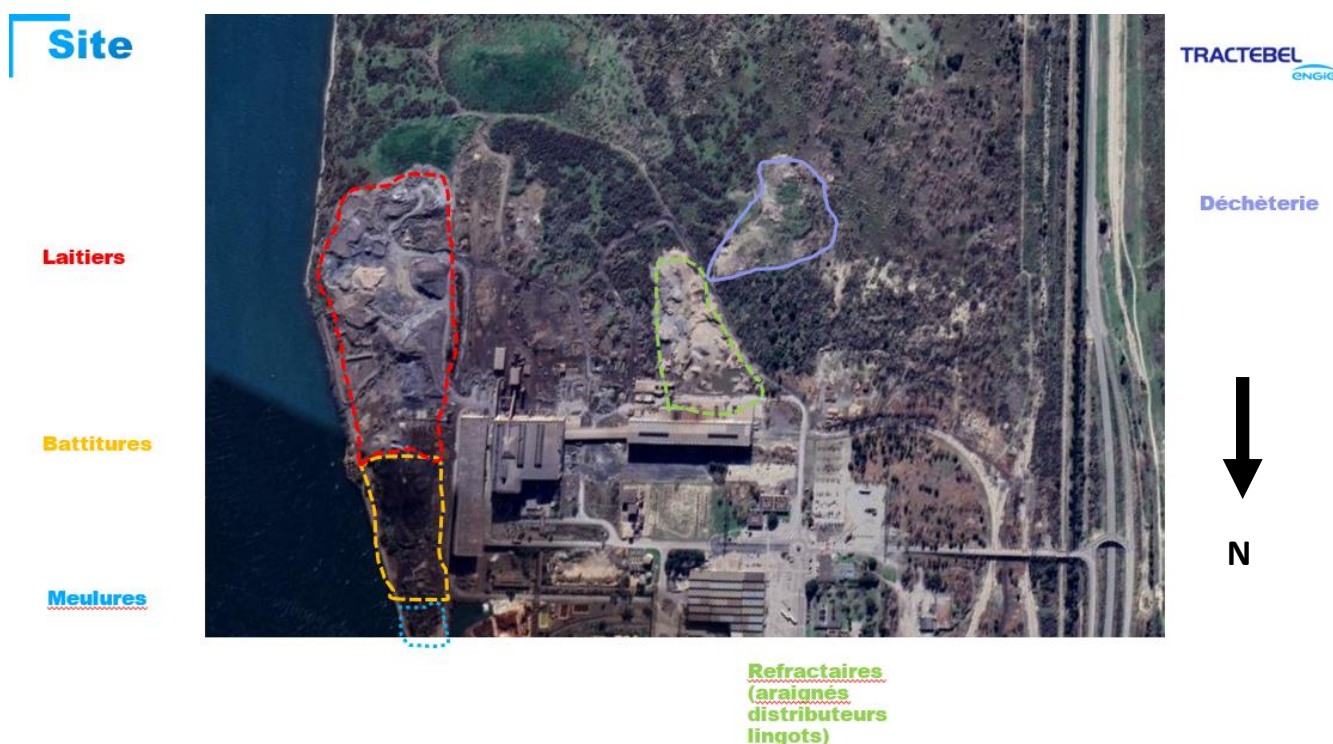
Figure 242: Plan de stockage des déchets du site
