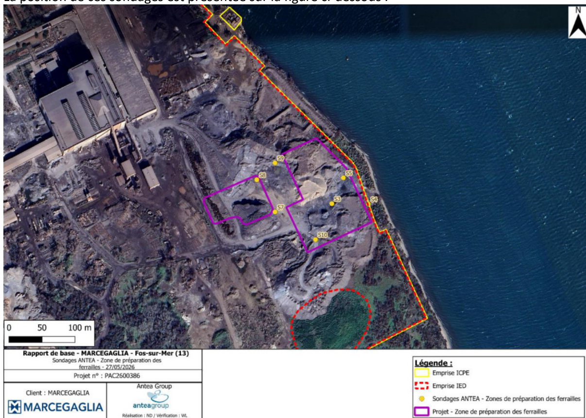
Figure 10 : Position des sondages – Zones de préparation des ferrailles
