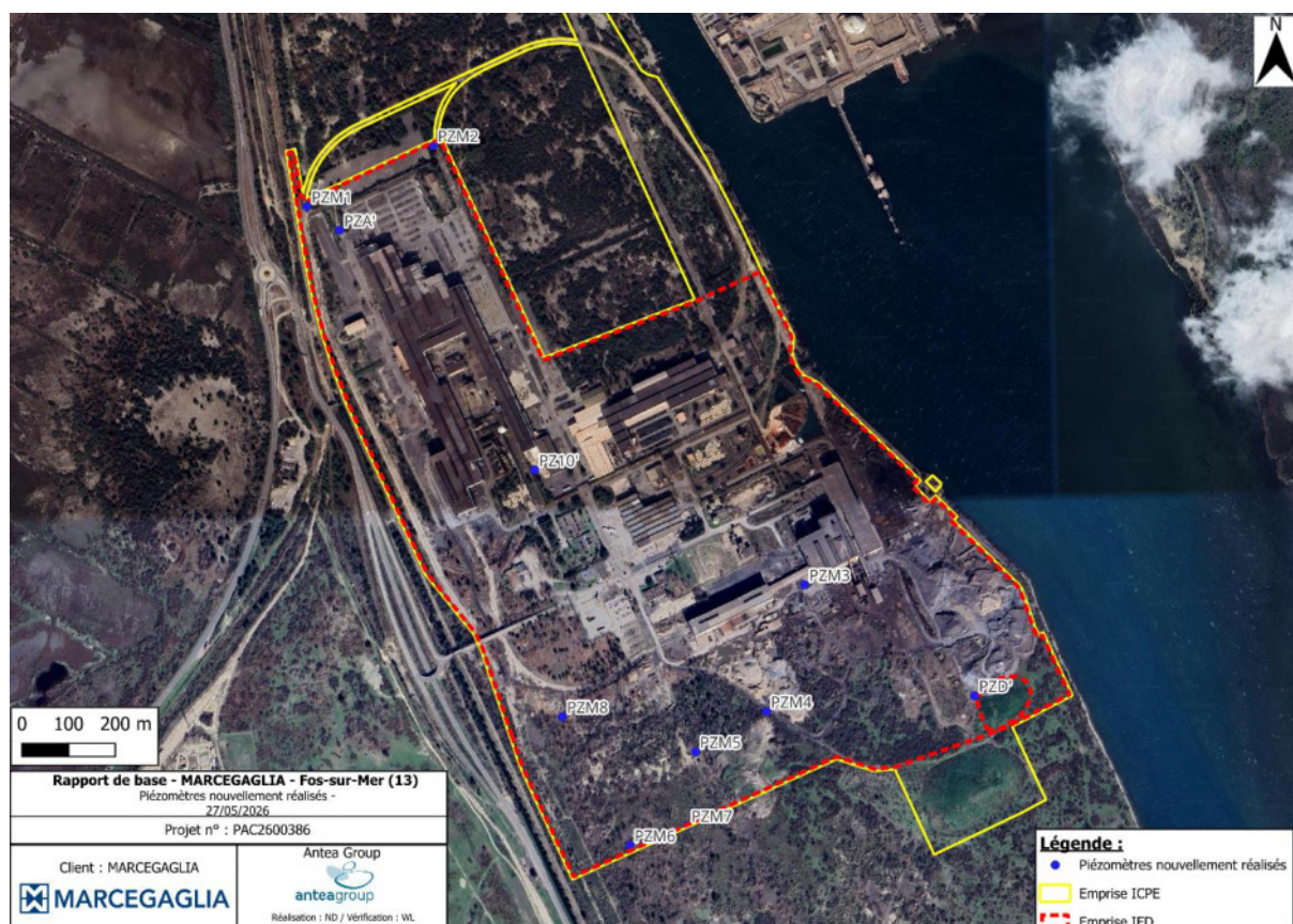
Figure 15 : Localisation des piézomètres nouvellement réalisés
