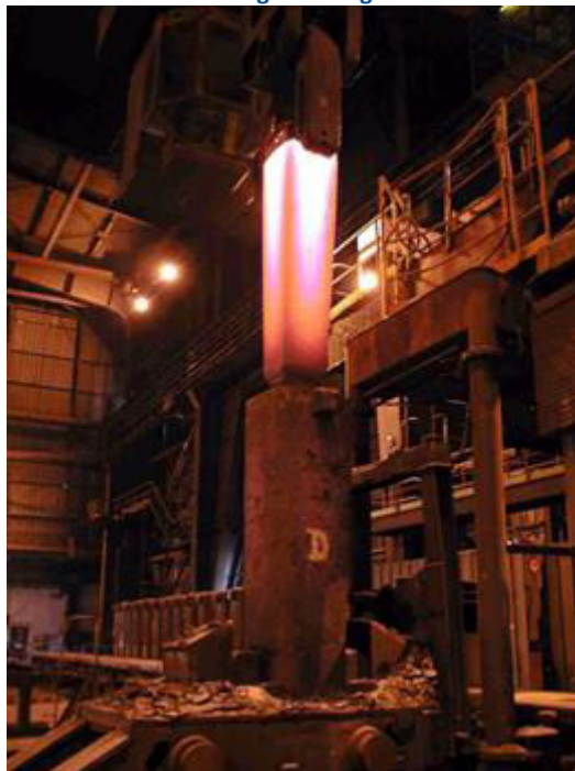
Photo 3 : Démoulage d'un lingot
