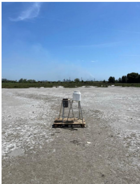
Figure 2. - Photographie de jauges BERGERHOFF pour métaux (droite) et PCDD/F (gauche)
