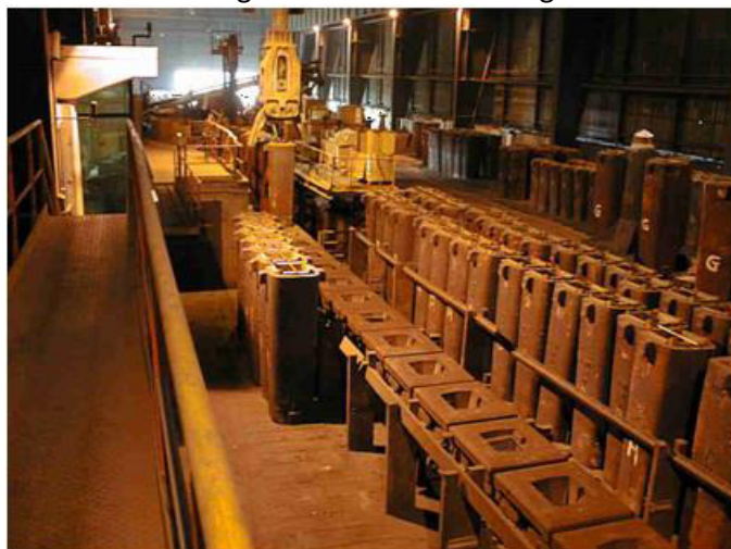
Photo 2 : Zone de stockage des lingots avant démoulage
