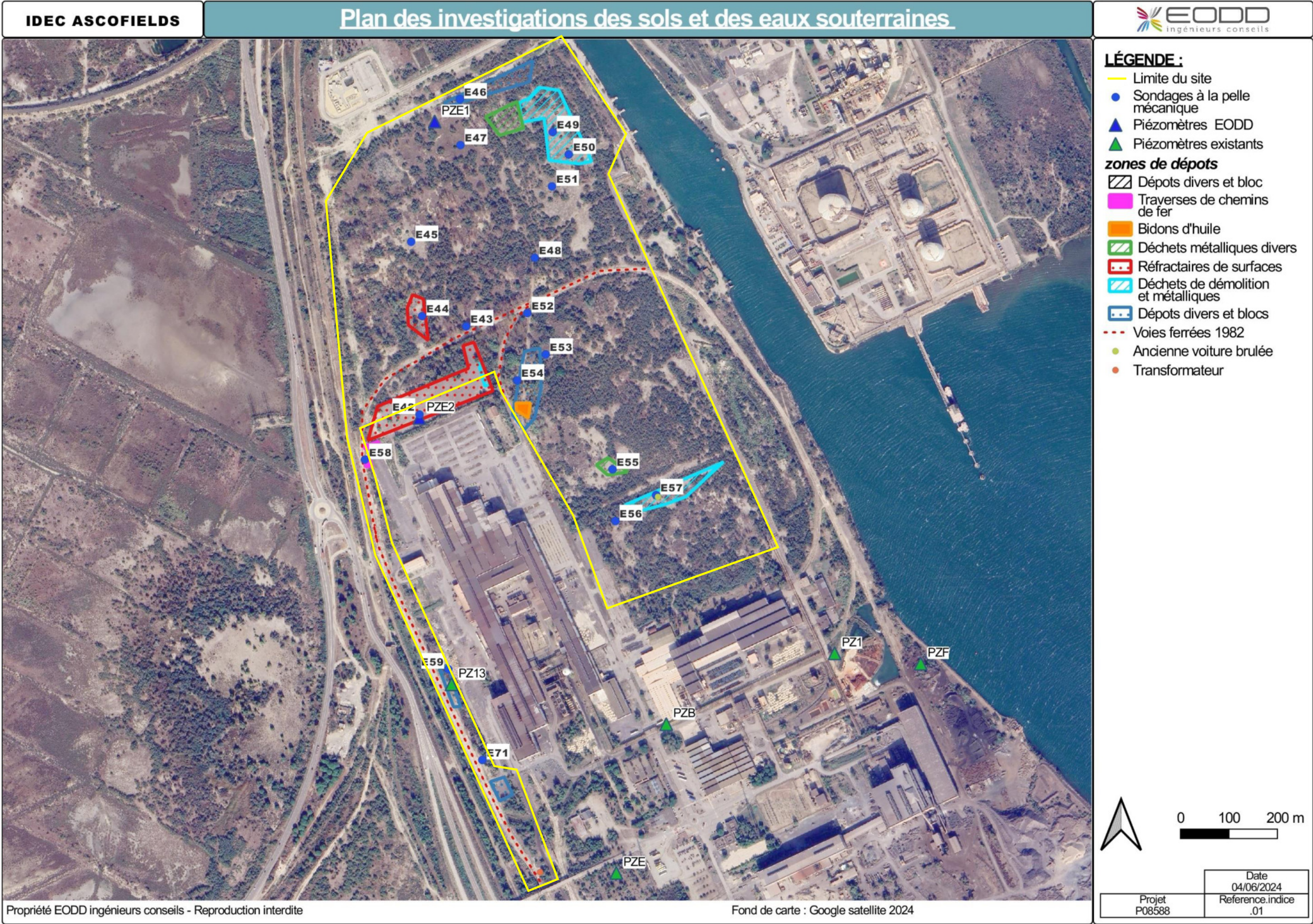
Illustration 8 : Localisation des investigations réalisées par EODD
