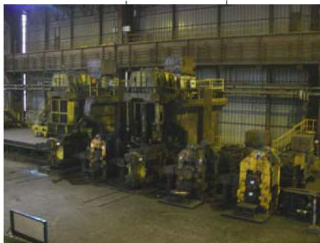
Photo 7 : Cages de laminages des billettes
