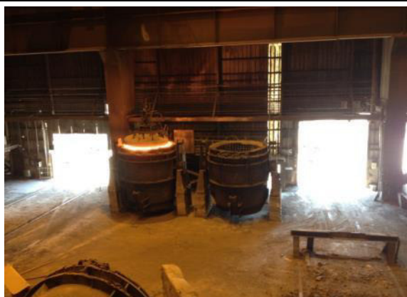
Photographie 3 : Préchauffage des poches
