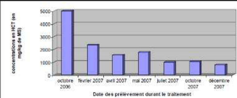
Evolution de la concentration en Hydrocarbures (en mg/kg de MS) dans les terres durant le traitement biologique.
