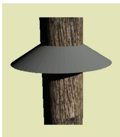
Dispositif du cône anti-prédateur (source : http://nichoirs.net/ )
