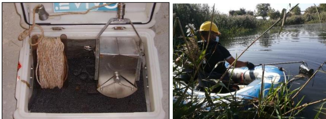
Figure 7. Benne Ekman et Prélèvement dans la lagune ASCOMETAL
