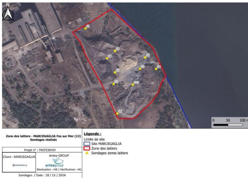
Figure 54 : Localisation des sondages réalisés au droit de la zone des laitiers
