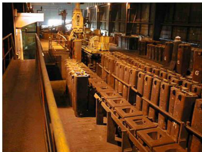
Photo 2 : Zone de stockage des lingots avant démoulage
