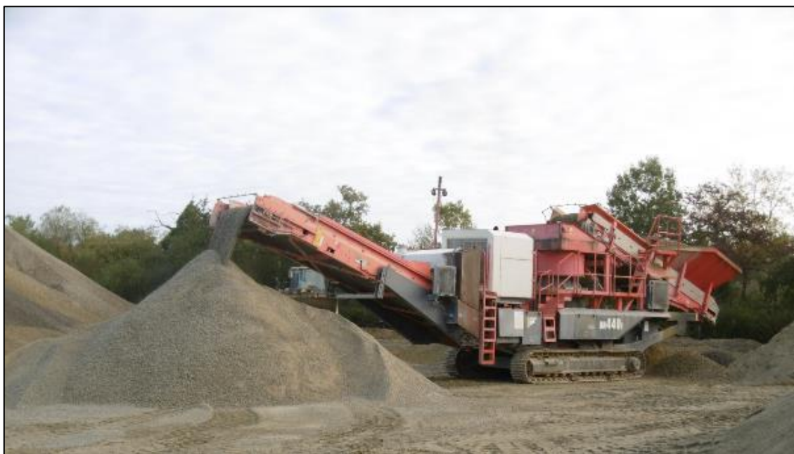
Figure 8 : Visuel d'une installation mobile de concassage et de criblage semblable à celle prévue (site de Sainte-Pazanne)
