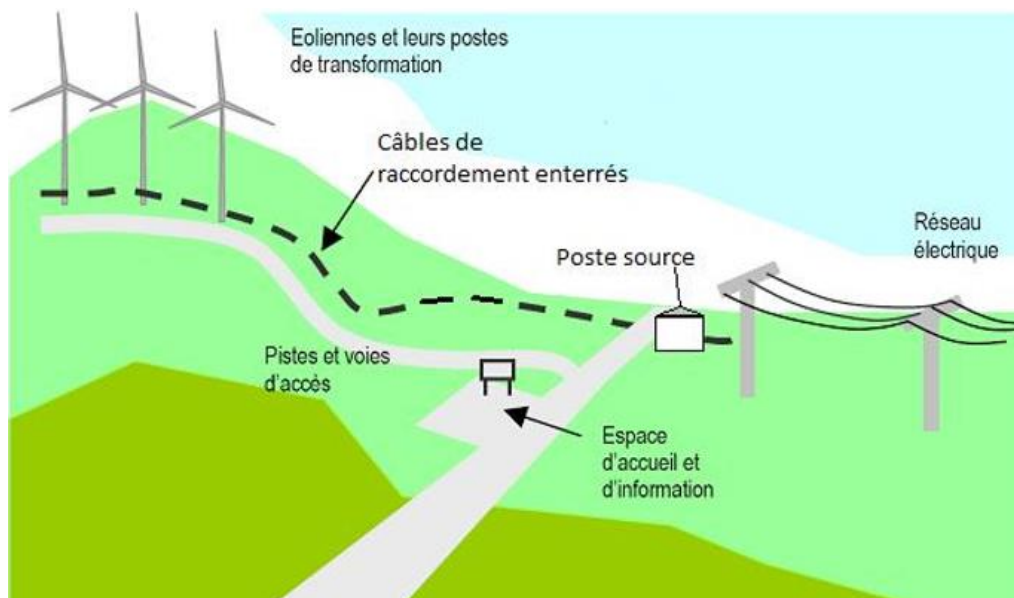
Figure 18 : Schéma descriptif d'un parc éolien
