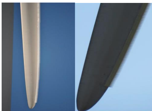
Illustrations du montage des serrations sur les pales d'une éolienne (source VESTAS : 0048-1259_V01 - STE Technical description)
