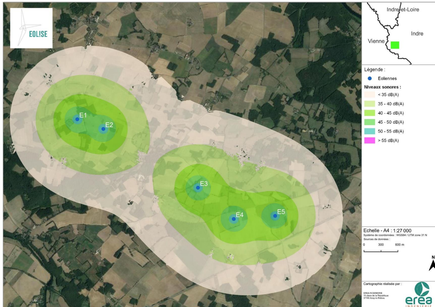
Isophones pour l'implantation de 5 éoliennes de modèle V150 pour un vent de vitesse standardisée de 10 m/s (vent de sud-ouest)
