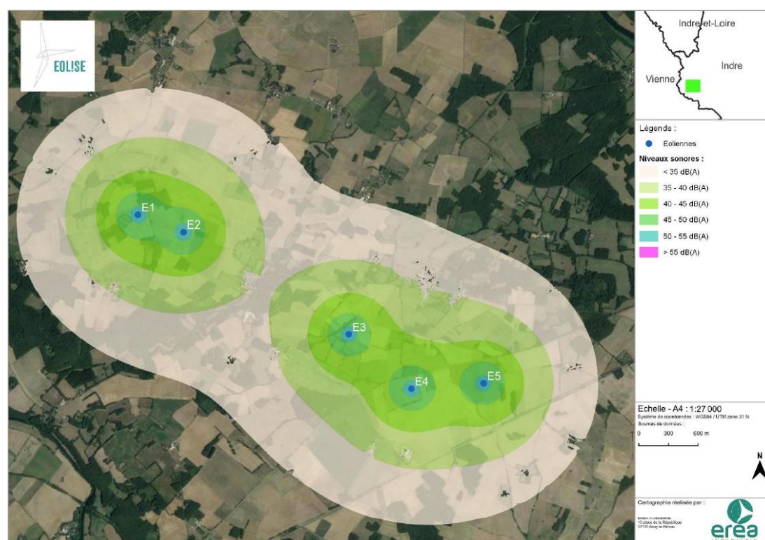
Carte 152 : Isophones pour l'implantation de 5 éoliennes de modèle V150 pour un vent de vitesse standardisée de 10 m/s (vent de nord-est) (Source : EREA INGENIERIE)
