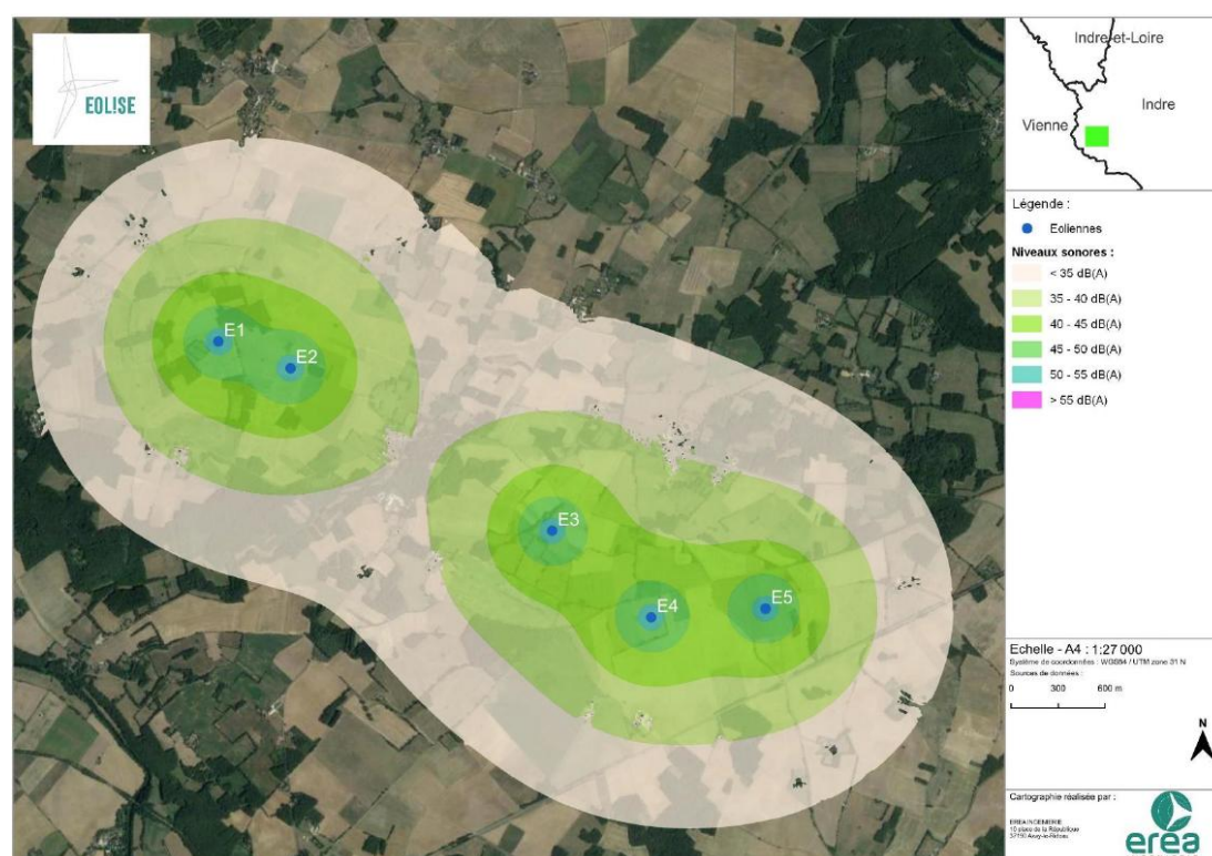
Carte 153 : Isophones pour l'implantation de 5 éoliennes de modèle V150 pour un vent de vitesse standardisée de 10 m/s (vent de sud-ouest) (Source : EREA INGENIERIE)
