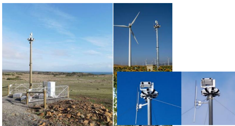
Photographie 54 : Système IdentiFlight (montage sur une tour de 10 m sur le parc) et vue détaillée de la tête d'imagerie avec huit objectifs grand angle disposés à 360° et la caméra stéréo pivotante et orientable (Source : THEMA Environnement)
