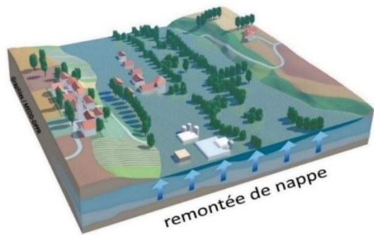
Figure 14 : Le phénomène d'inondation par remontée de nappe (Source : georisques.gouv.fr)
