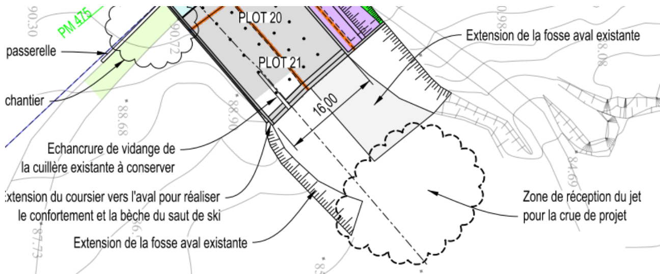
Figure 52 : Emprise des terrassements du bassin de réception
