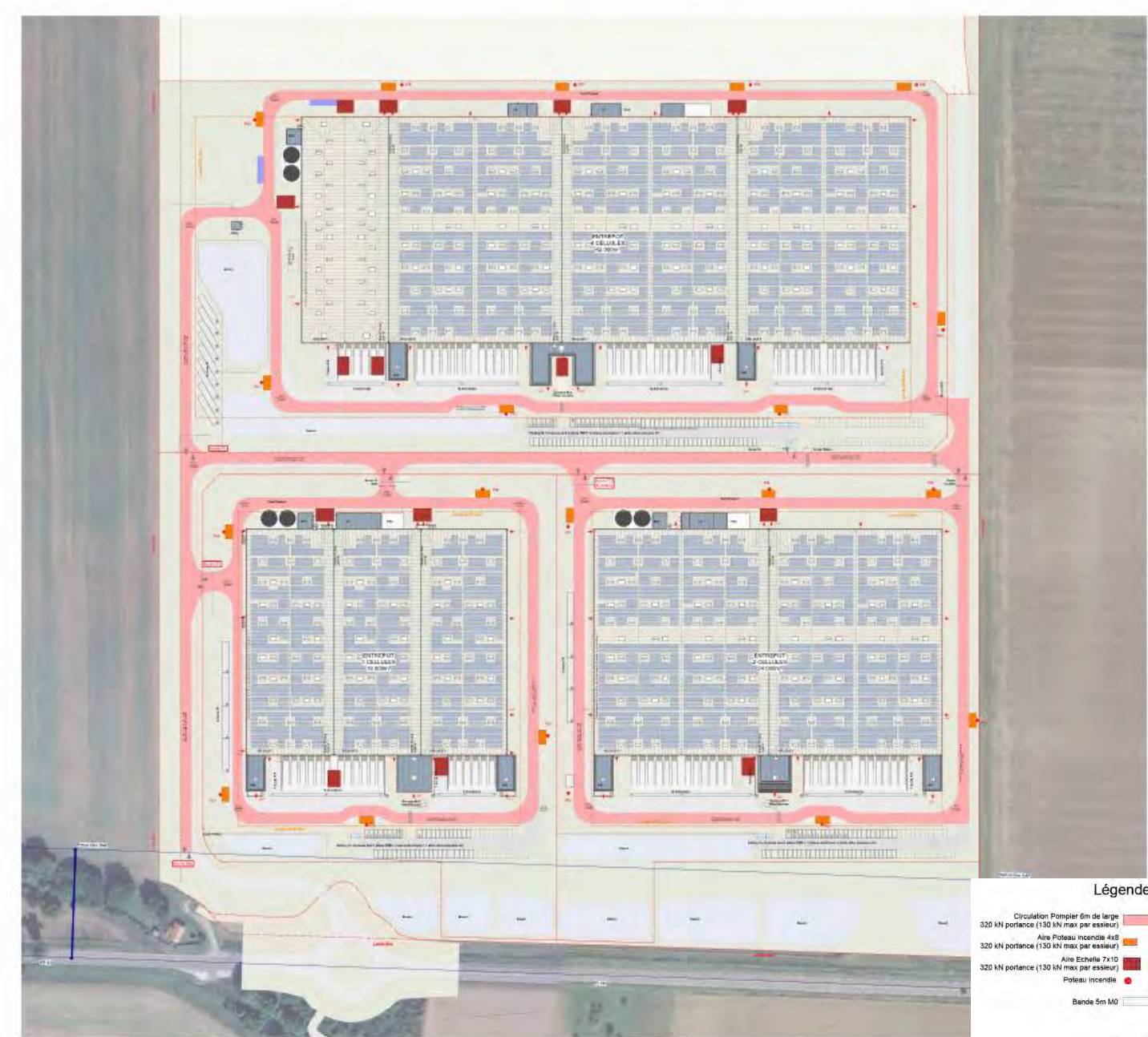
Figure 15 : plan d'implantation des poteaux incendie
