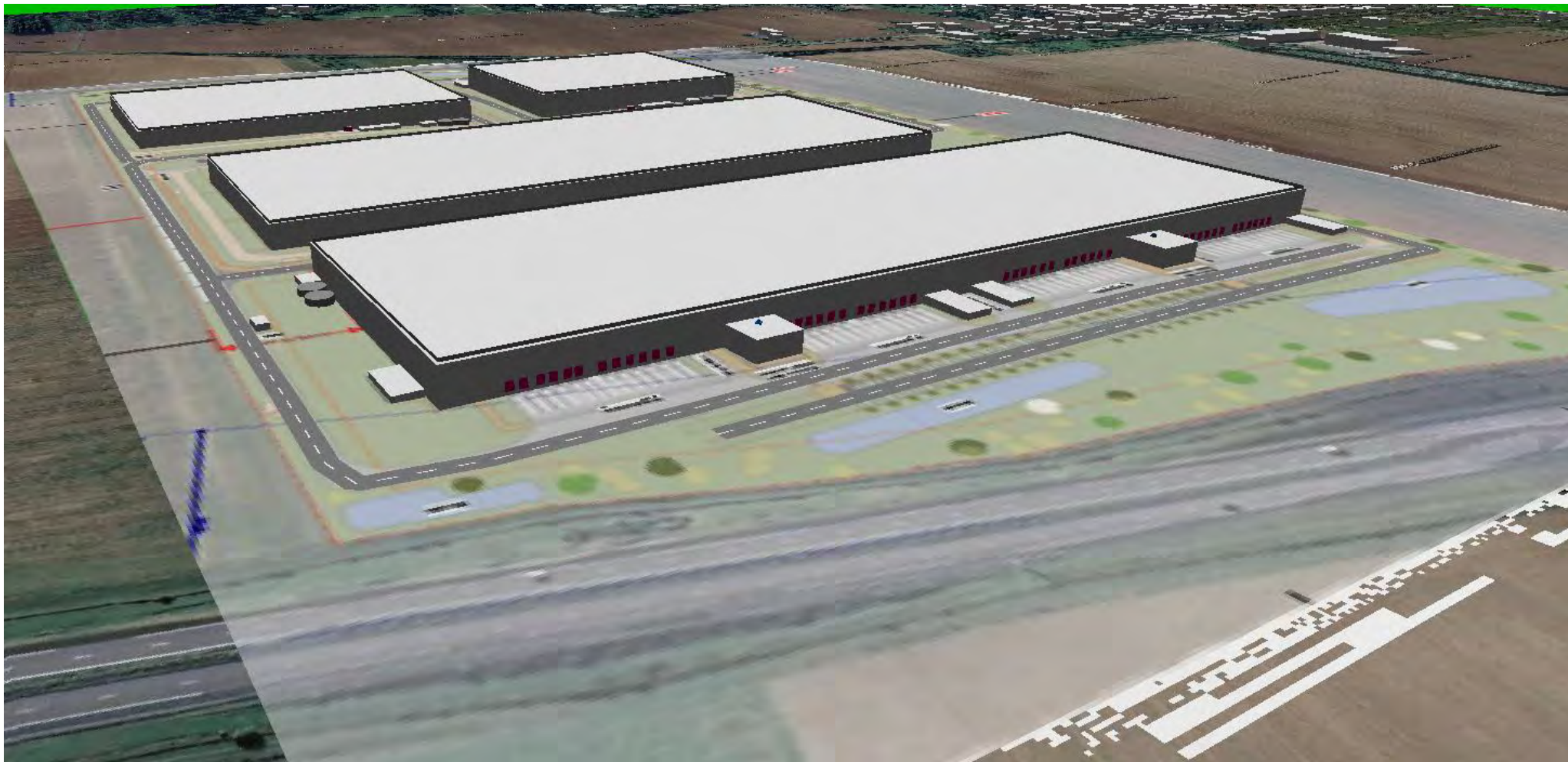
Localisation des sources sonores modélisées – Vue 3D du modèle CadnaA (vue du Nord)
