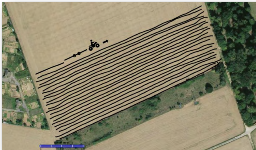
Figure 2 : parcours d'acquisition et points de mesures (maille large). L'écartement inter profil peut varier.
